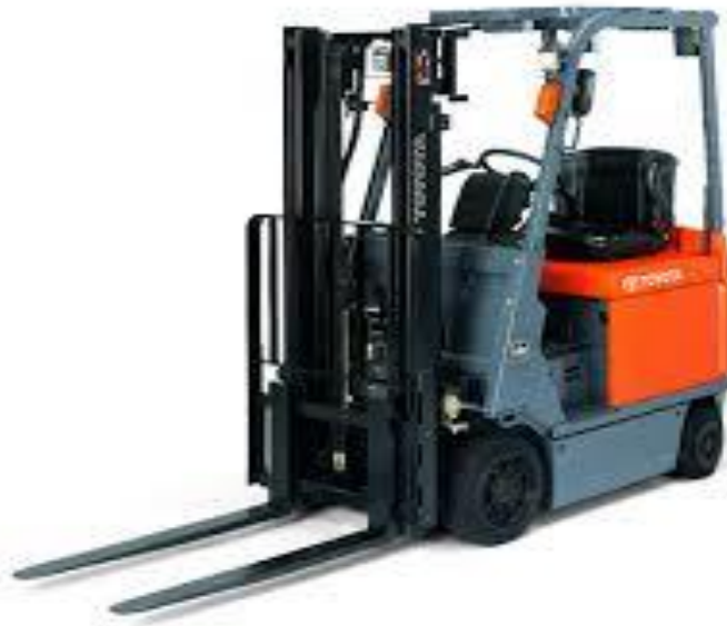
Περονοφόρο με αντίβαρο (counter balanced forklift truck)
